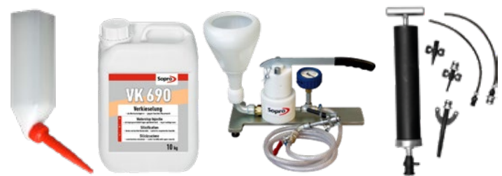
Sopro Verkieselung VK 690 und die dazugehörigen Trichter zum drucklosen Einbringen des flüssigen Injektionsmittels sowie die Injektionspresse und die Handpresse zum Einbringen im Niederdruckverfahren.
